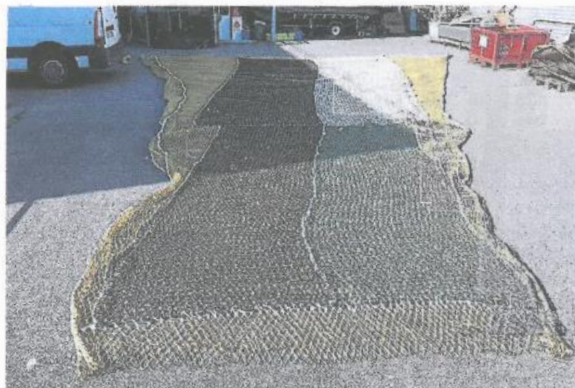
Panneau en mailles carrées mis sur la face supérieure du gorget du chalut : il comporte quatre sous-panneaux de couleurs différentes pour tester l'effet sur l'échappement, avec le noir en témoin pour tester le blanc et le vert.
