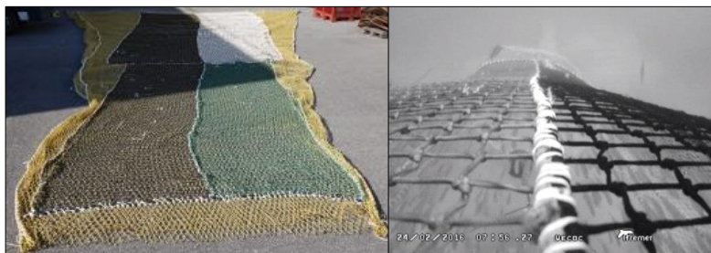
Panneau à mailles carrées en 90 mm sur le gorget de l'AZUR (à terre à gauche, en mer à droite) - © Ifremer
