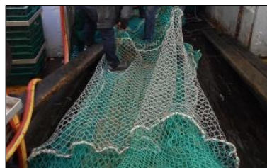
Premier panneau en T90 sur le parc de tri (navire L'ECUME DES JOURS) © Cobrenord
